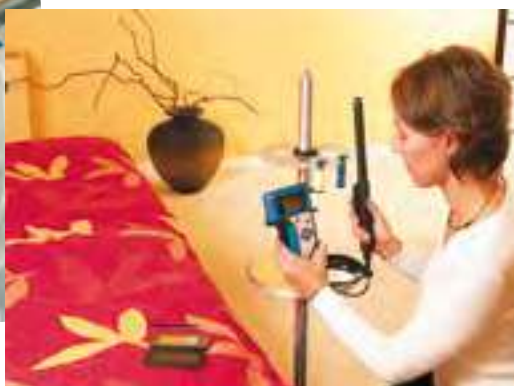
Pose du matériel dans une chambre permettant de recueillir des composés organiques volatils.
