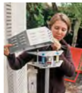
Portoir installé à l'extérieur pour mesurer le monoxyde de carbone, les composés organiques volatils et les aldéhydes.
